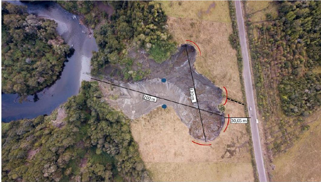
Figura 3: Detalle de la remoción en masa catastrada por el SERNAGEOMIN cercana al sitio de estudio en el sector de Las Compuertas. Fuente: Emol.
